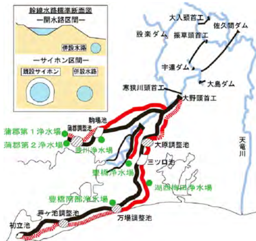
豊川用水（開水路+パイプライン）
