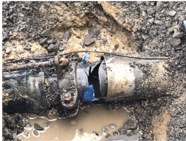
①-130 : φ 100VP (管体破損)
