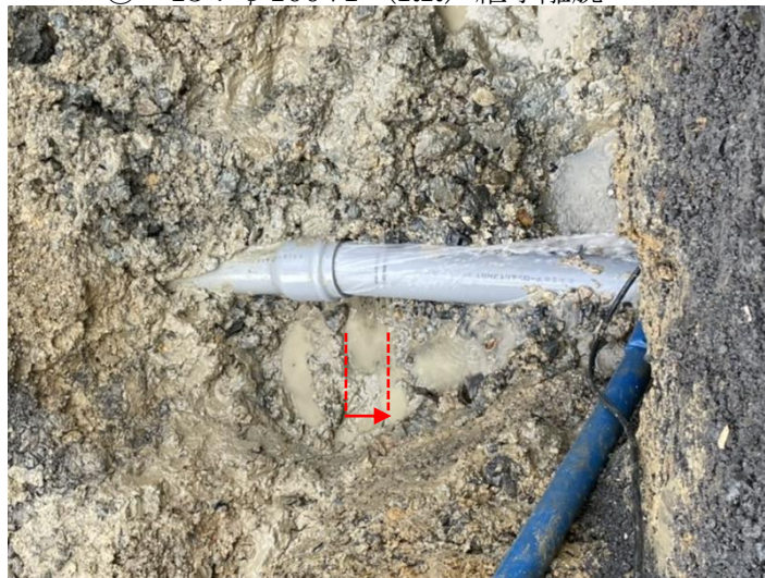
①-95 : φ300DIP (継手離脱)
