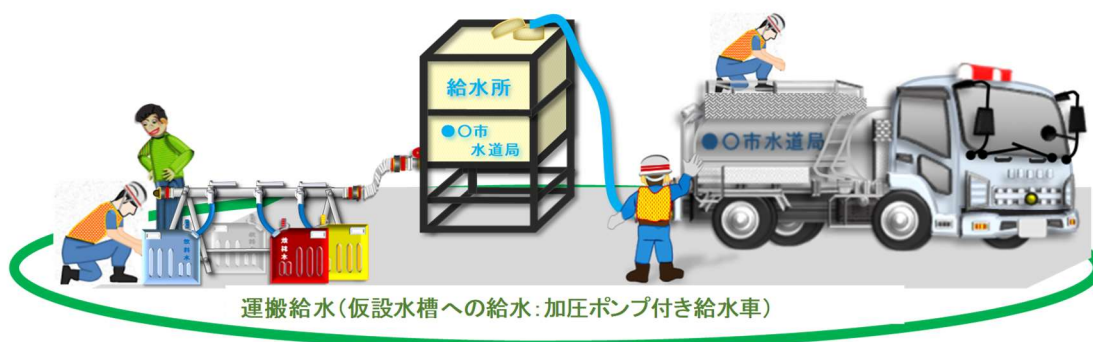
図 1-2 仮設水槽による給水
