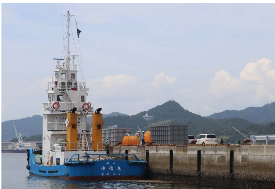
写真 5-1 船舶（四国整備局）からの給水 船に積載している水をホースで陸上の給水タンクに給水
