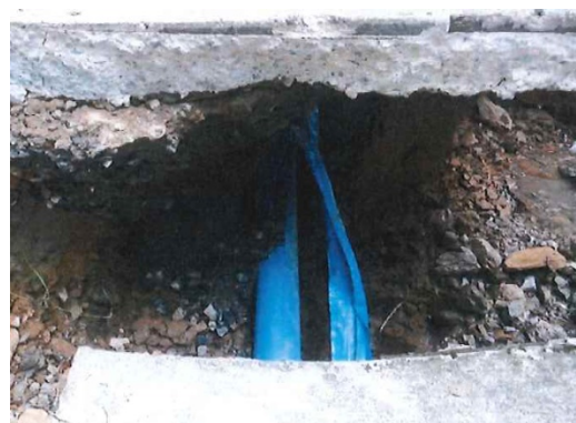
写真 4-6 橋梁の流失に伴う添架管の管体破断 (愛媛県宇和島市三間町川之内)
