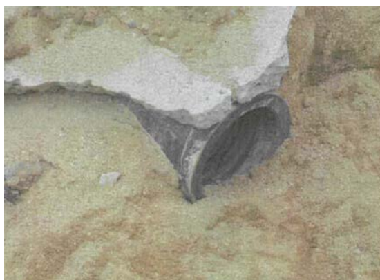
写真 4-11 水流による河川堤防の崩壊により添架管取付部の継手の抜出し (倉敷市真備町有井：大日橋添架管)
