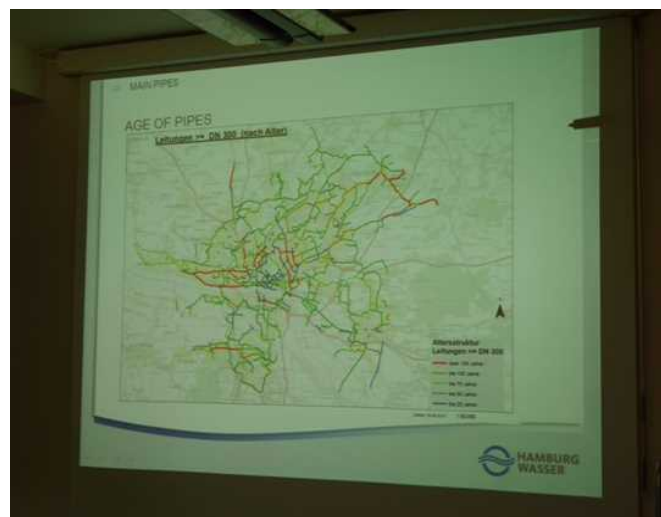
写真 8 管路の経年化状況
