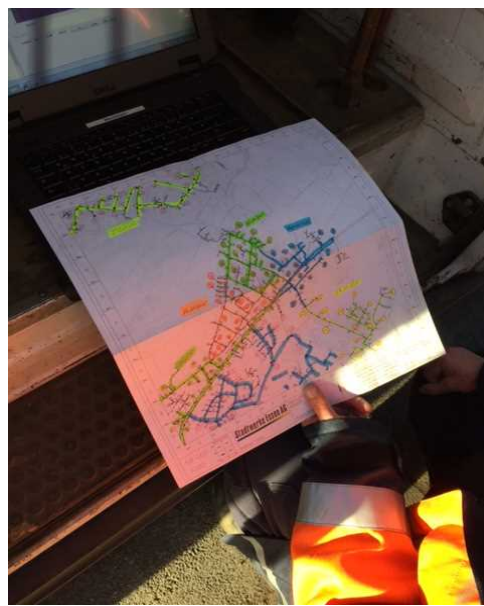
写真 17 漏水調査のエリア分け図面
