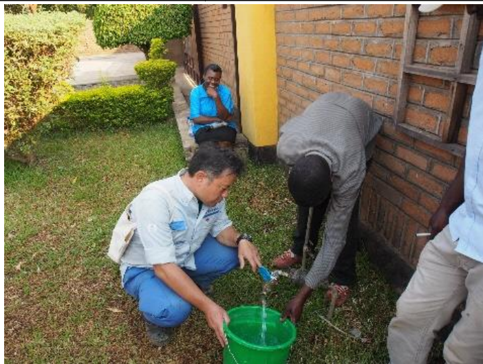
メーターの精度確認調査の実施
