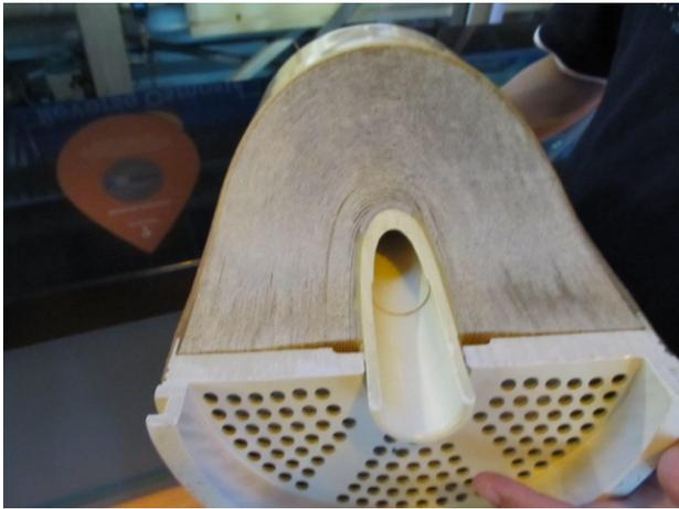
【写真 97 : RO 膜 断面図】
