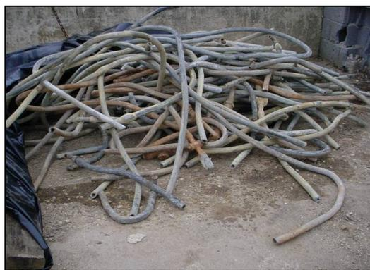
図 39 撤去した鉛給水管
