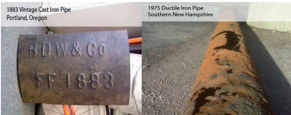
図-19 1883年製の鋳鉄管（左）と1975年製のダクタイル鋳鉄管（右）
