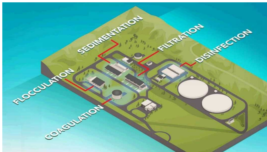
図 23. 浄水処理工程
